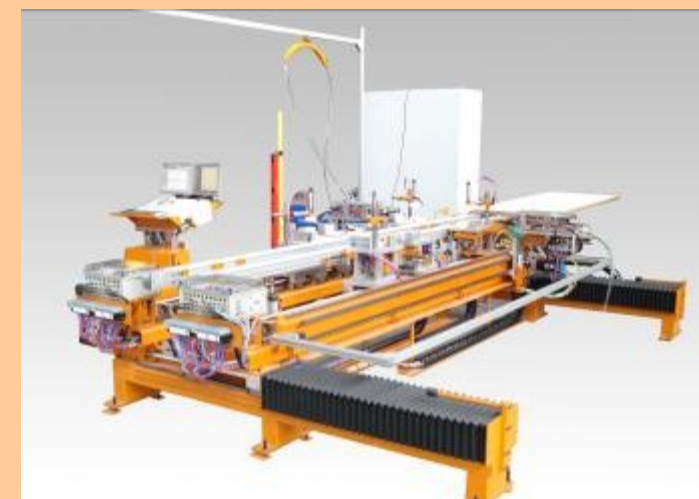
Horizontale Rahmenpress- und Schraubmaschine mit automatischem Abtransport der Werkstücke.
