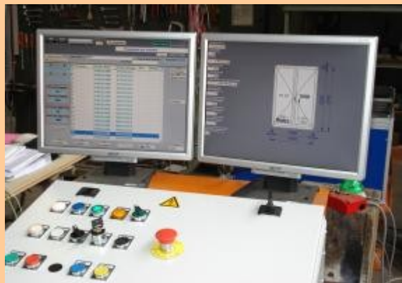
Steuerpult, welches mit einem Programmierungs-Terminal ausgestattet ist.
