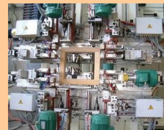
Beispiel für die Zusammenfügung eines kleinen Rahmens mit den Maßen 350 x 400 mm.
