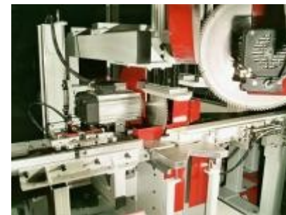
Stelle für das Schneiden der 45°- und 90°-Winkel
