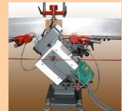
Escopleadora especial para realizar cortes a 45°
