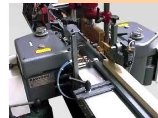
Escopleadora especial con cabezales en oposición
