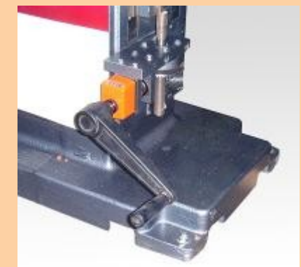
Ajuste vertical del cabezal por manivela y contador mecánico numérico
