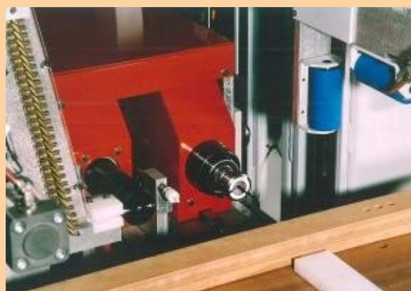
Unidad de anubado con mandril de atornillado CN
