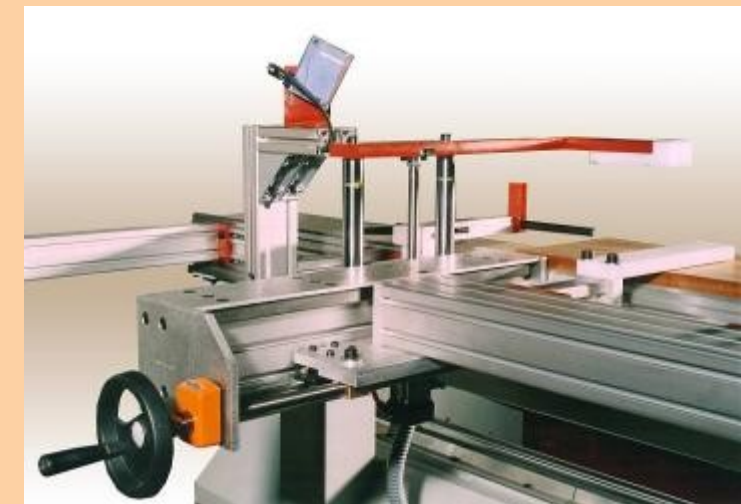
Detalle de la mesa equipada de una regla soporte con topes de apoyo que permite posicionar las piezas contra referencia. Evita los topes de la parte del mecanizado que pueden causar colisiones.
