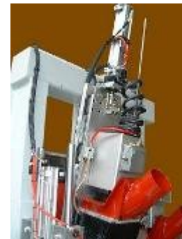
Unidad de perforación inclinada para realización de drenajes
