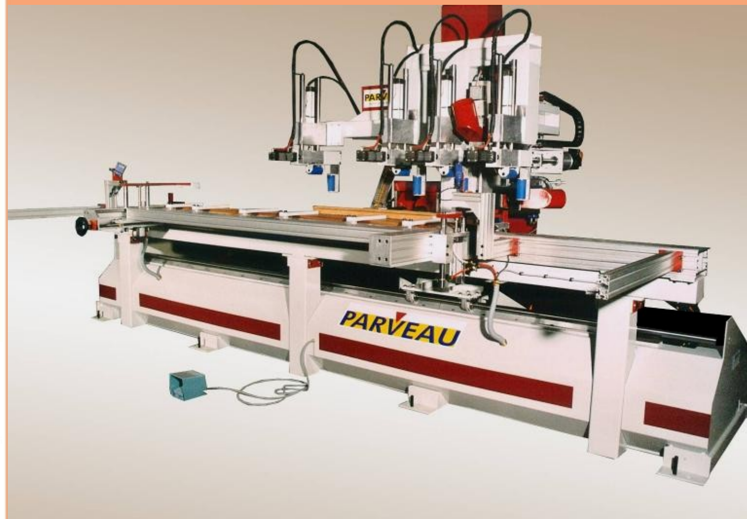
Ejemplo de un centro demecanizado 3120 equipado de 2 unidades de ranurado vertical y horizontal y de una unidad de anubado
