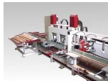
Ejemplo de un centro equipado de un tapiz de alimentación y de un almacén de almacenamiento de piezas mecanizadas
