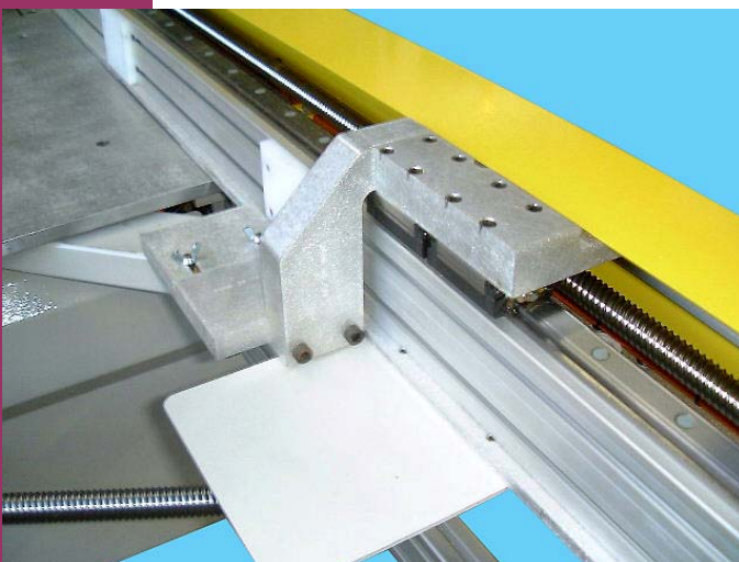
Vue de détail de la butée de règle à positionnement numérique. La programmation des cotes se fait au 1/10 ème de mm.
