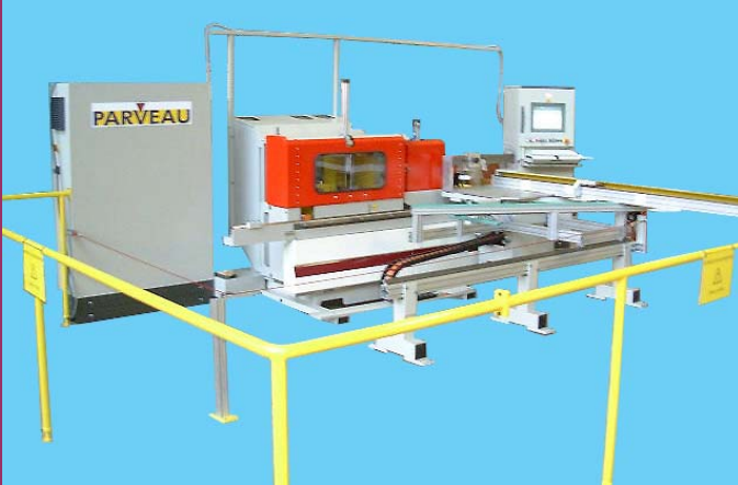
Vue d'ensemble de la machine. Tenonneuse simple type Converpro 921, équipée d'une scie, d'une toupie à positionnement numérique et d'un groupe de perçage en bout.
