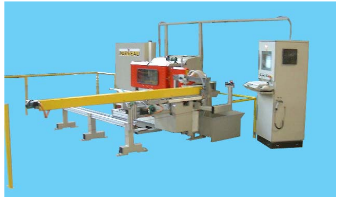
L'avance de la table est numérique avec optimisation des vitesses. L'inclinaison et le positionnement de la butée de règle sont numériques également.
