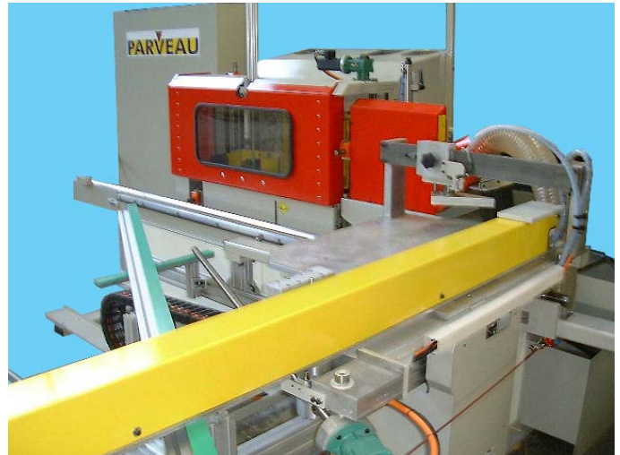
Avantages de cette machine : un algorithme spécialement étudié permet de compenser le positionnement de la butée en fonction de l'angle d'inclinaison de la règle. L'appel des programmes se fait par lecture d'un code barres sur la pièce par scanner évitant ainsi toute erreur de saisie de la part de l'opérateur.
