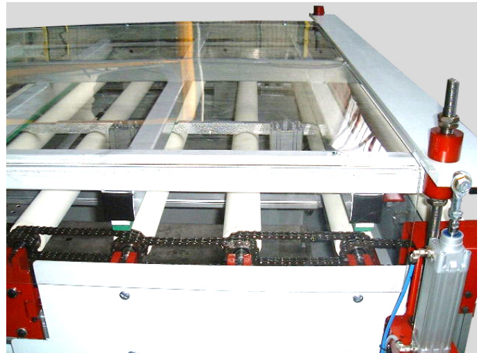
Vue de détails des rouleaux d'amenage des lames. Une poutre numérisée permet de régler la largeur d'amenage en fonction de chaque volet.
