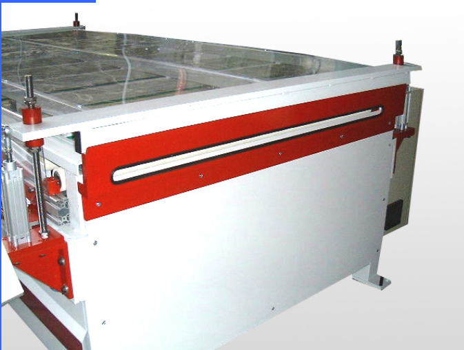
Vue de côté de la machine. Fente d'introduction des lames. Protection de l'ensemble de la machine par un carter en polycarbonate.
