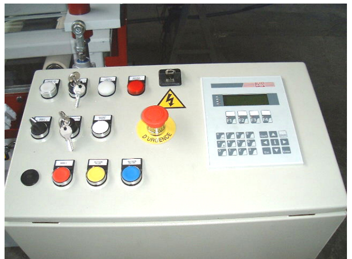
Vue de détails du pupitre de commande. Un lecteur code barre permet de régler automatiquement la poutre sans aucun saisie de la part de l'opérateur.
