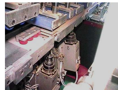
Perçage et défonçage par dessous
