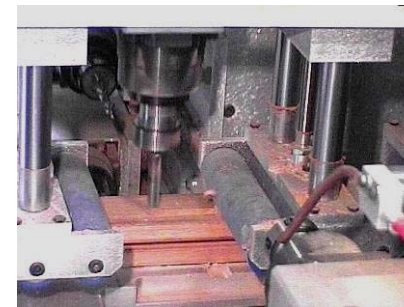
Pièce en cours de défonçage vertical
