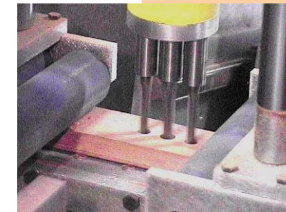
Perçage des 3 trous
