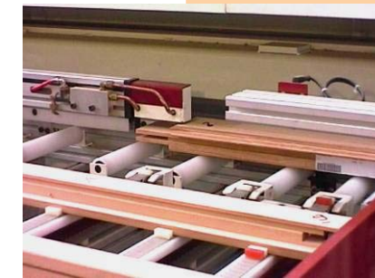
Pousseur numérique monté sur 3 axes permettant d'introduire les pièces dans la machine
