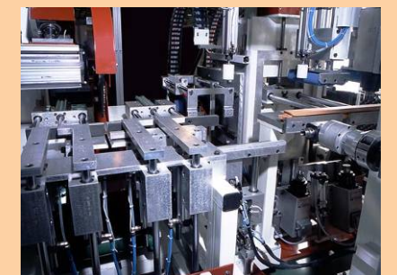
Unité de tronçonnage radial (située à gauche)
