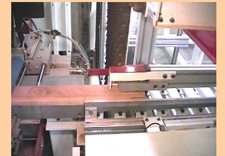
Introduction d'une pièce par le pousseur numérique
