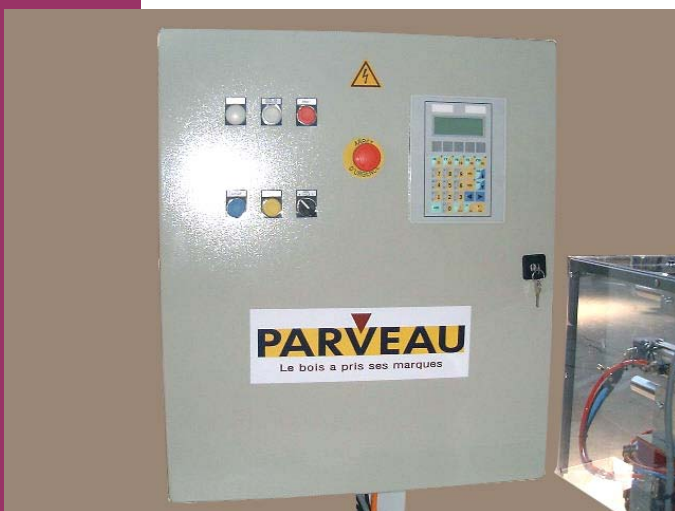
Vue du pupitre de commande équipé d'un positionneur pilotant la butée. La programmation des cotes se fait au 1/10 ème de mm.
