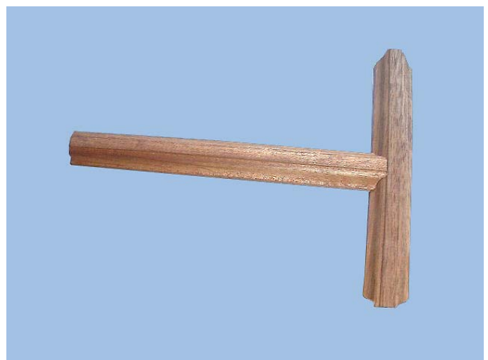
Vue de détail des petits bois entaillés et coupés à longueur par la machine.
