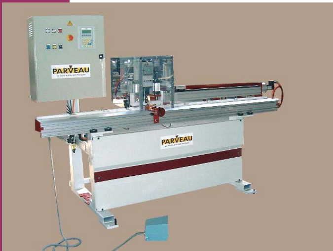
Vue d'ensemble de la machine. Celle-ci est destinée à mettre de longueur les petits bois et à les contre profiler.
