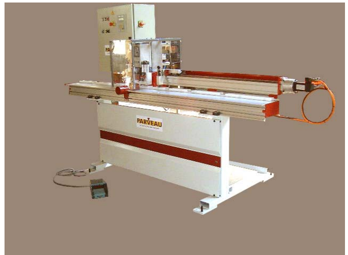
Machine composée d'une butée numérique et d'une défonceuse verticale à avance semi-automatique.
