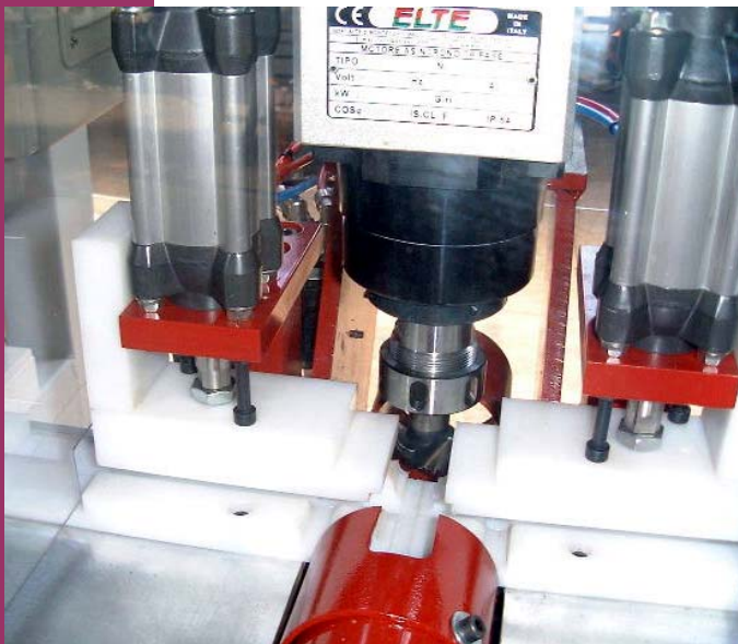
Vue de détail du porte-outil de défonce vertical équipé d'une fraise de forme (douce). Moteur 12000 t/min. 2 presseurs de part et d'autre maintiennent le petit bois.
