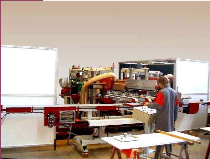
Vue d'ensemble de la machine. La machine est insérée dans une cabine insonorisée. Possibilité d'alimentation automatique des bois en sortie de moulurière, ou d'empilage automatique.
