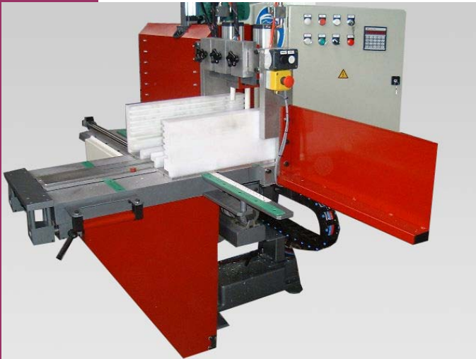
Poste d'alimentation. L'avance de la table est manuelle (possibilité de la motoriser en option).
