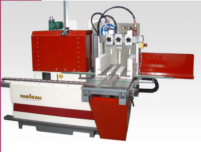
Vue d'ensemble de la machine. La machine est construite sur la base d'une tenonneuse simple Converpro, entièrement cartésienne.
