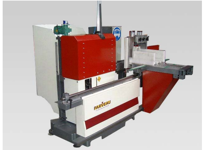
Vue d'ensemble de la machine côté gauche. Le réglage de la toupie est numérique (mémoire de 99 programmes).
