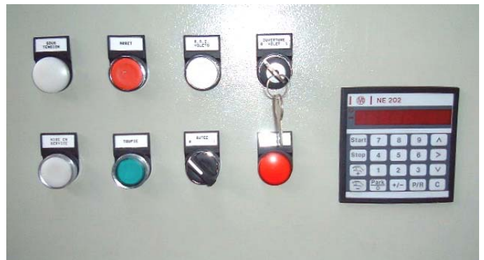
Vue du pupitre de commande. Réglage de la hauteur de la toupie par positionneur électronique IVO (99 programmes mémorisés).
