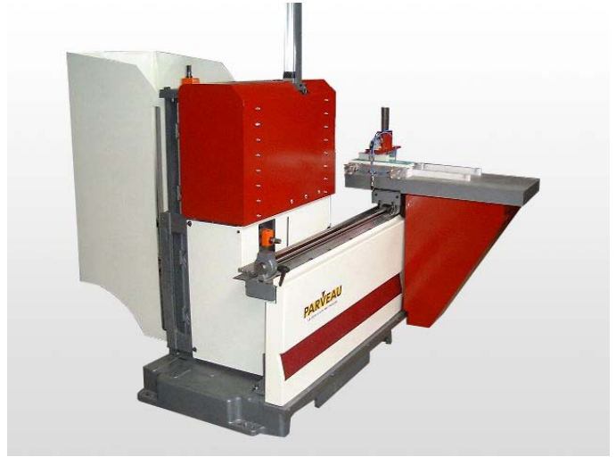
Vue d'ensemble de la machine côté gauche. Le réglage de la toupie se fait au moyen de compteurs Siko, depuis l'extérieur de la machine.
