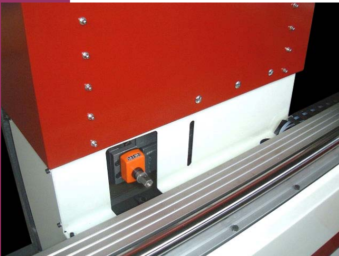
Vue de la vis de réglage de l'axe horizontale de la toupie. Réglage par manivelle et compteurs Siko. Le réglage ne nécessite pas d'arrêt du porte-outil.
