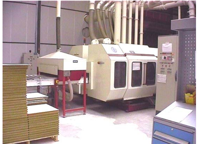
Module de dépoussiérage des panneaux en sortie de ligne.
