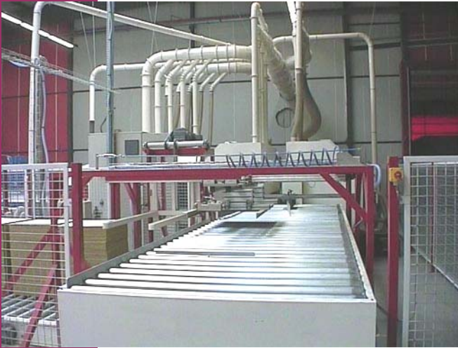
Robot de déplage des panneaux. Table à rouleaux motorisés permettant l'alimentation manuelle ou automatique de la ligne en panneaux.
