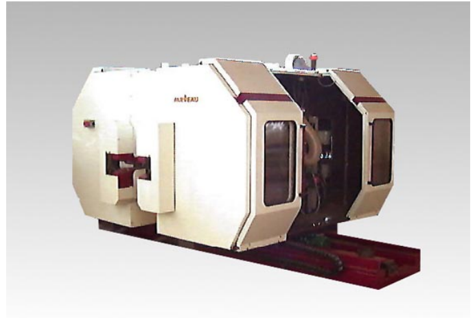
Vue d'ensemble d'une des deux calibreuses doubles. Les portes coulissantes permettent un accès facile à l'intérieur de la machine.
