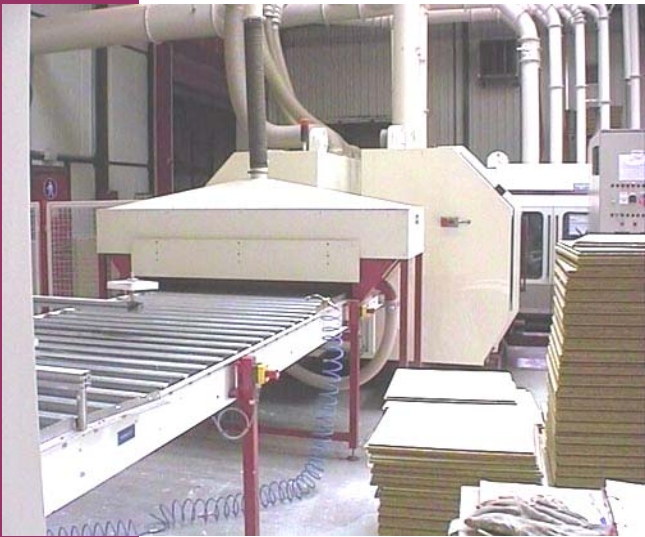
Vue de la sortie de la ligne de calibrage. On distingue le module de dépoussiérage avec une table à rouleaux motorisés permettant de transférer les panneaux vers le poste de peinture.
