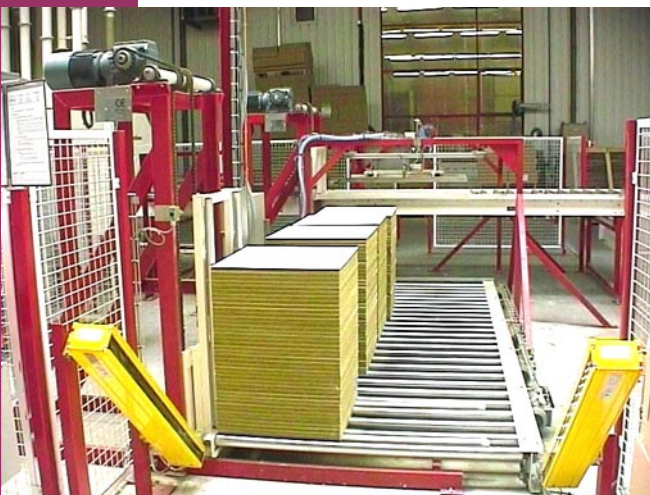
Ensemble de défilage automatique travaillant en continu. Ici le stockage des panneaux
