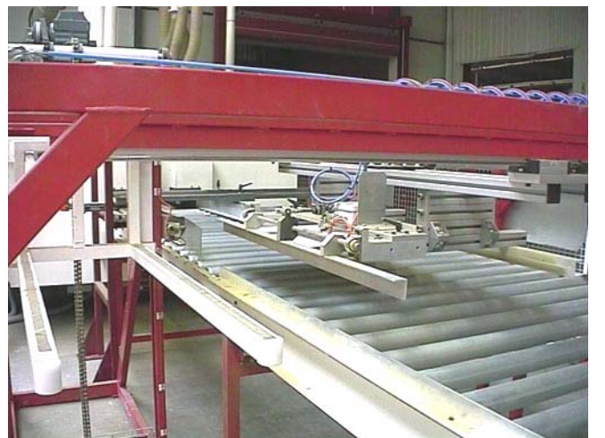
Robot de défilage des panneaux alimentant les deux calibreuses doubles.
