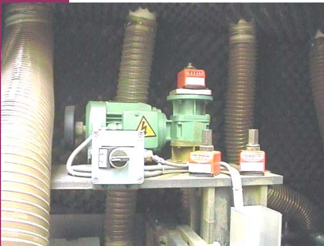
Réglages verticaux des porte-outils avec motorisation du monte et baisse des presseurs
