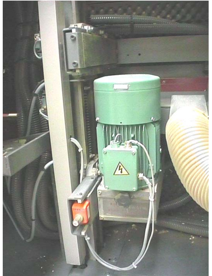
Vue du porte-outil toupie. Le réglage horizontal
