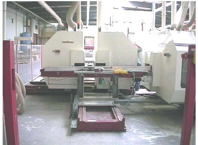
Vue du transfert entre la calibreuse N°1 (en face) et la calibreuse N°2 (à droite).
