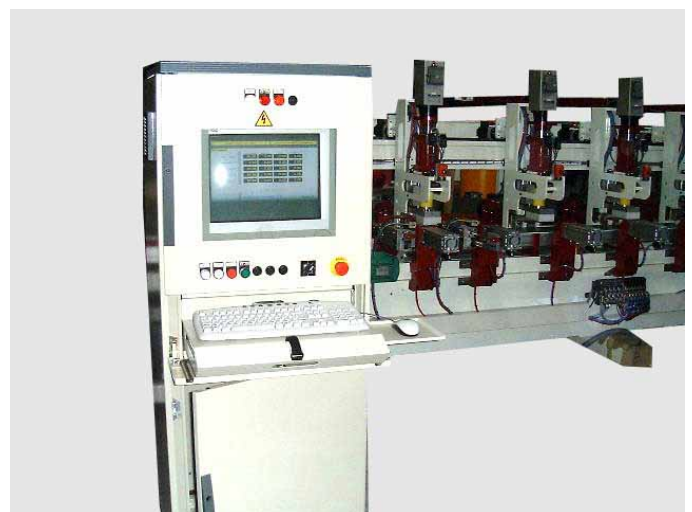
Pupitre de commande composé d'un micro-ordinateur.
