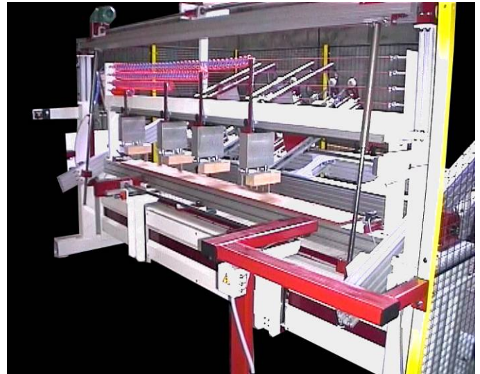
Vue de la table, des 4 presseurs. Sur les côtés on distingue les vis d'inclinaison des unités de perçage.
