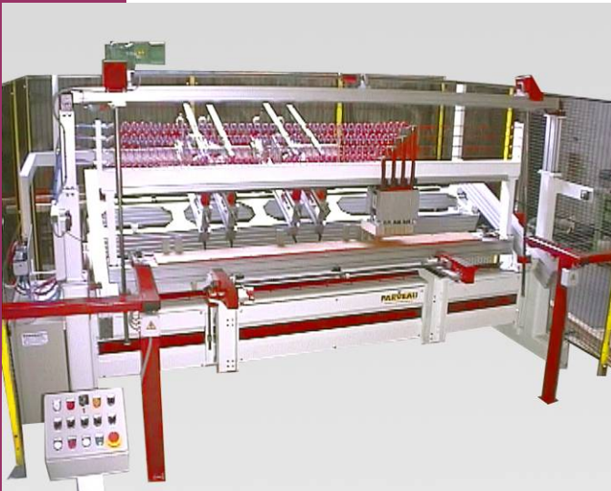
Vue d'ensemble de la machine composée d'une table réglable en hauteur et en profondeur, d'un banc de 4 unités de perçage inclinables, d'une butée latérale gauche et de 4 presseurs verticaux.
