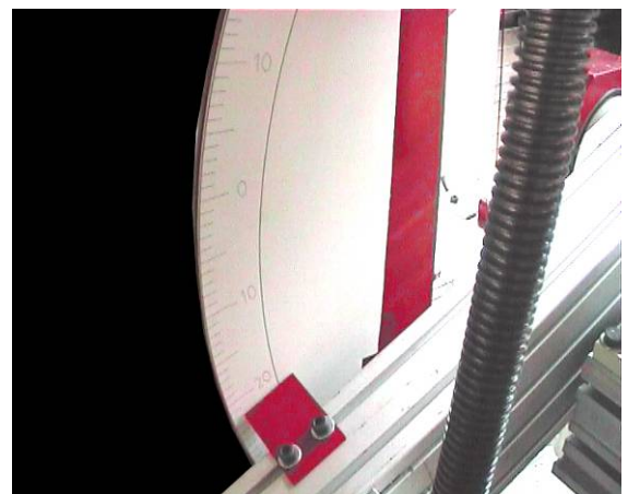
Vue du secteur indiquant l'angle d'inclinaison des unités de perçage.
