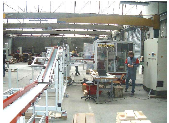
Vue d'ensemble de la ligne comprenant un aménagement des pièces par tapis, la magasin chargeur, une tenonneuse rainureuse double.
