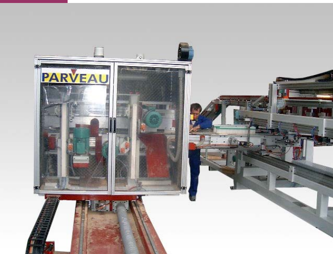
Vue de la rainureuse double avec à droite le magasin chargeur automatique.
