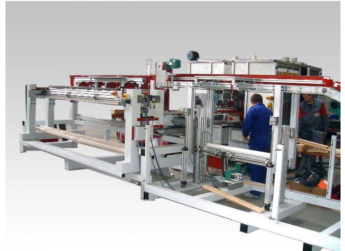
Vue d'ensemble de la ligne. Au centre le magasin chargeur vertical.
