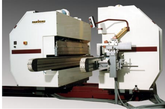
Vue générale d'une rainureuse double
