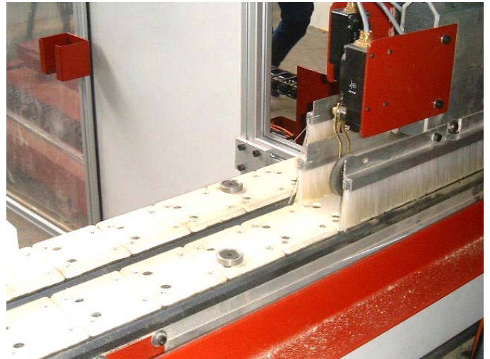
Vue du décalage numérique des chaînes pour l'usinage de lames à point de Hongrie.
