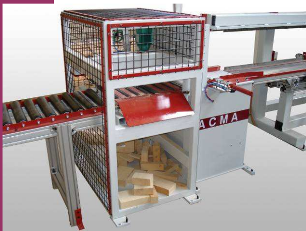
Vue d'ensemble de la tronçonneuse. En sortie de tronçonneuse, un dispositif pneumatique pousse les pièces dont la longueur ne correspond pas à la série en cours de fabrication, dans un récipient.
