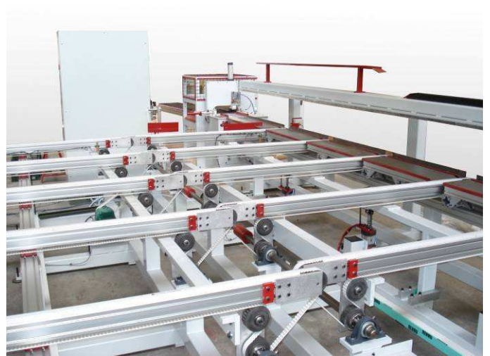
Une série de transferts à chaînes permet de créer un stock tampon et d'alimenter automatiquement une tronçonneuse en bout de ligne.
