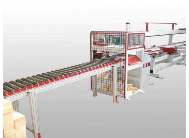
Vue de la sortie de la tronçonneuse équipée d'une table à rouleaux libre. Les pièces sortent à pousse pousse et s'accumulent sur les rouleaux libres.
