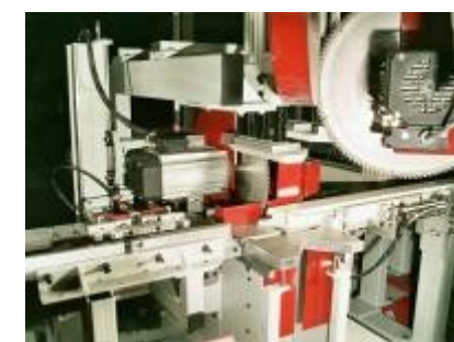
Poste de tronçonnage pour coupes à 45°, à 90°, entailles en « V » et coupes en pointe
