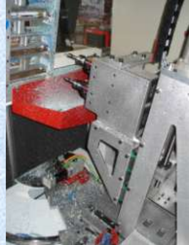
Vue de détail des porte-outils (2 unités inclinées de défonçage). L'ensemble est numérisé verticalement transversalement et angulairement.
