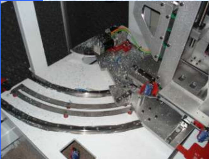
Vue de détail de l'orientation numérique des porte-outils. Cet angle est fonction de l'inclinaison des écharpes à usiner.
