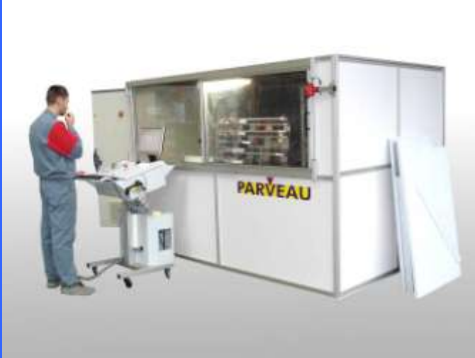
Vue de d'ensemble de la machine. Une cabine assure l'insonorisation et la protection de l'opérateur.
