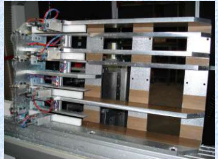
Vue de détail du système de bridage des pièces. 4 écharpes peuvent être usinées en même temps : 2 pour volets à droite et 2 pour volets à gauche
