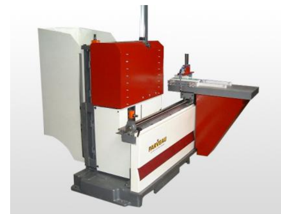
Vue d'une grugeuse PVC standard avec une seule toupie à réglages manuels.
