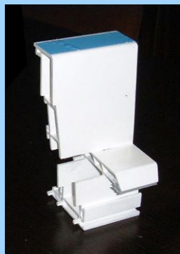
Exemple de pièce grugée
