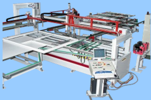
Cadre avec meneau et traverse intermédiaire en cours d'usinage
