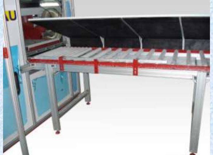
Vue de détail de la table d'entrée à rouleaux libres. Au dessus un capot d'insonorisation permet de réduire les bruits de sciage.
