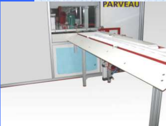
Vue de la table de sortie. Celle-ci est basculante pour évacuer certaines chutes.
