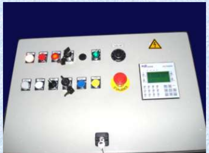
Vue de détail du pupitre de commande pilotant la lame mobile de la scie. Un lecteur code barre permet un réglage sans saisie manuelle de la part de l'opérateur.
