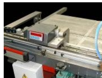
Exemple d'une table grande largeur avec rallonge et butée de règle. L'affichage digital de la cote est au 1/10 ème de millimètre.
