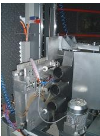
Toupie avec arbre long de 500 mm, moteur 7,5 kW (10 CV) équipée d'un pare-éclat automatique
