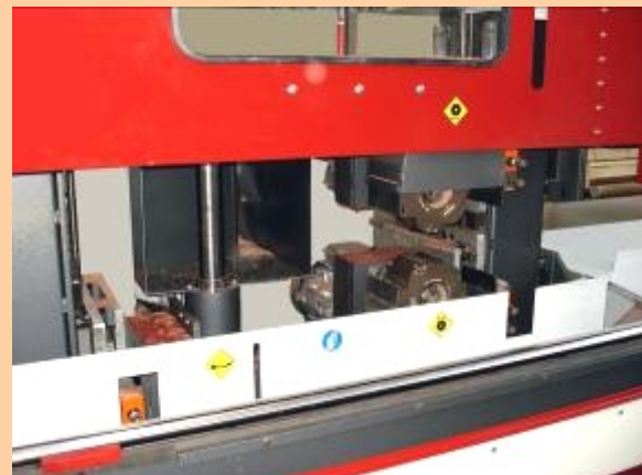
Exemple de machine équipée de 2 dérouleurs Ø 200 mm et d'une toupie. Capacité de passage en hauteur 250 mm.
