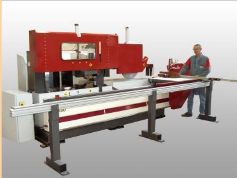
Machine équipée d'une servante permettant de maintenir des bois longs et lourds. L'avance de la table peut être manuelle ou automatique.
