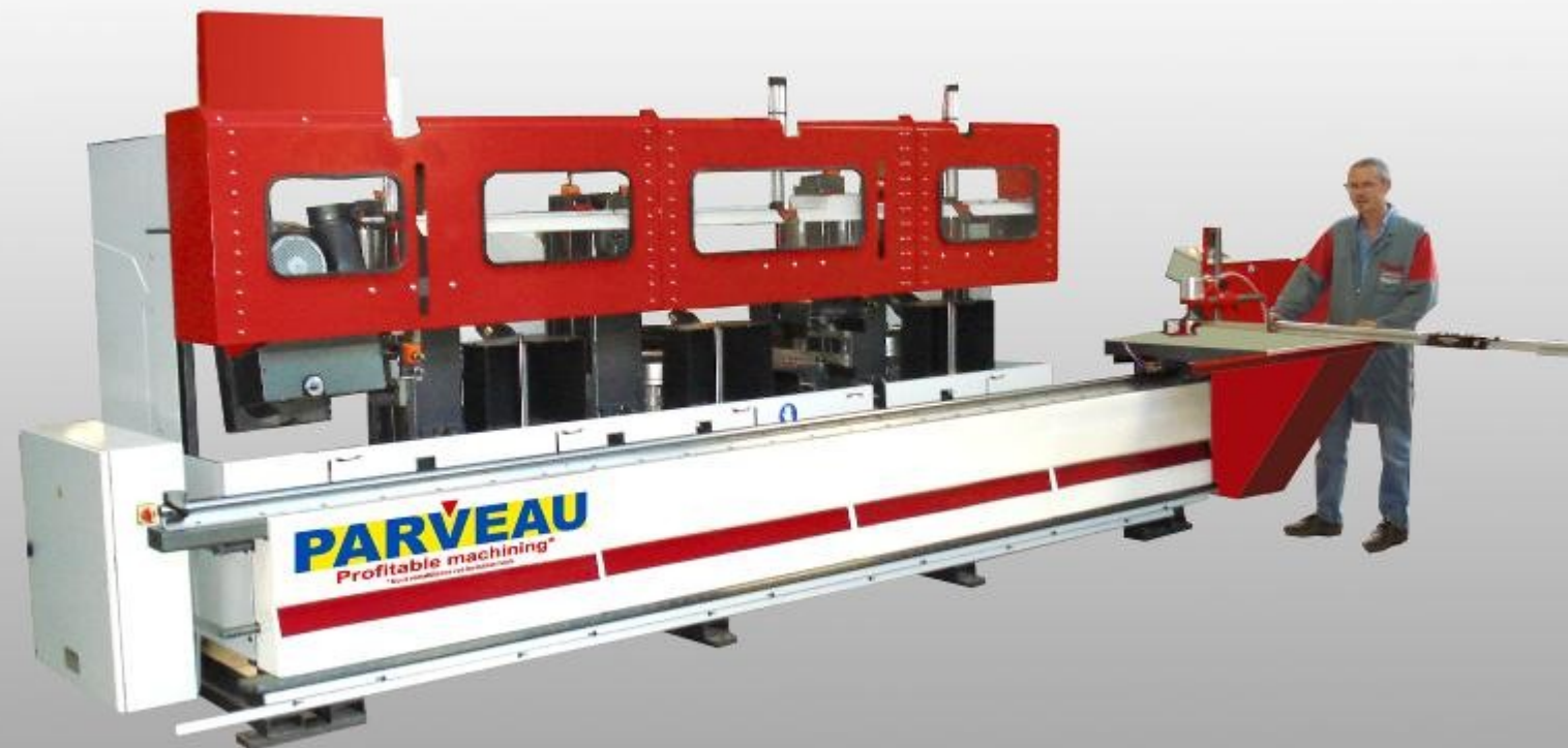
Tenonneuse 925 équipée de 6 porte-outils : 1 toupie, 2 dérouleurs et 3 autres toupies dont une avec arbre inclinable universel
