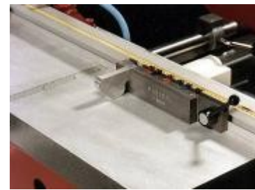
Règle aluminium inclinable de 0 à 50° avec butée escamotable et repères de couleurs.
