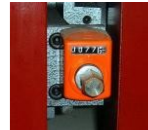
Compteur mécanique numérique. Tous les réglages des porte-outils s'effectuent depuis l'extérieur sans arrêt machine.
