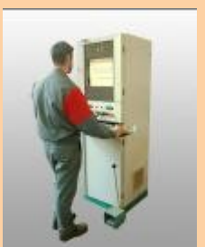
PC monté sur armoire de commande
