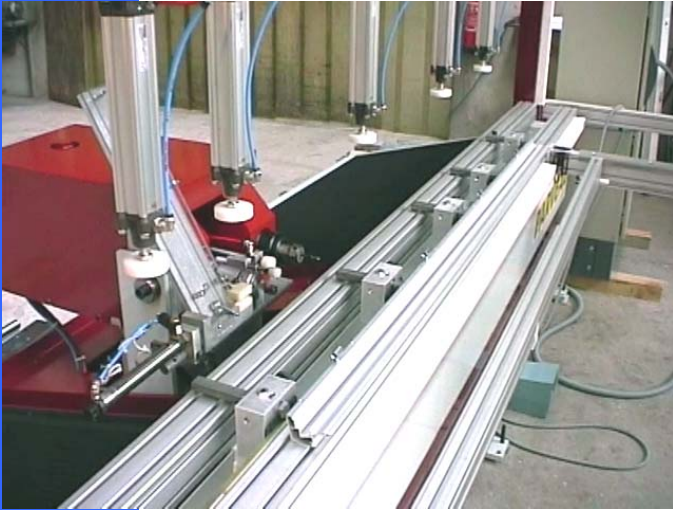
Vue d'ensemble avec la tête à positionnement numériques, les presseurs verticaux, les butées d'indexage des profils.
