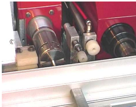
Vue de détail de la tête avec l'agrégat de perçage à droite, le palpeur de profondeur au centre et l'agrégat de vissage numérique des fiches à gauche.
